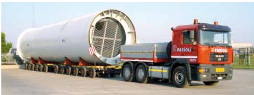
Figura 10 - Convoglio eccezionale per il trasporto per un tronco di tubo diametro 4 m dei piloni
