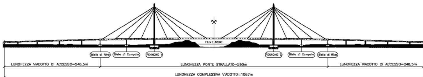
Figura 1 - Assieme del viadotto sul fiume Adige
