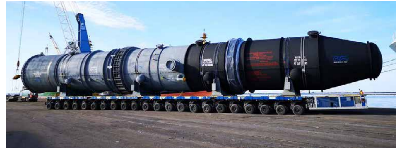
SPMT - Carros tipo MSPE EVO 2 - Más de 160 ejes disponibles - Capacidad de carga total de 9,500 toneladas.
