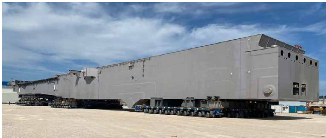
SPMT - Carros tipo MSPE EVO 2 - Más de 160 ejes disponibles - Capacidad de carga total de 9,500 toneladas.
