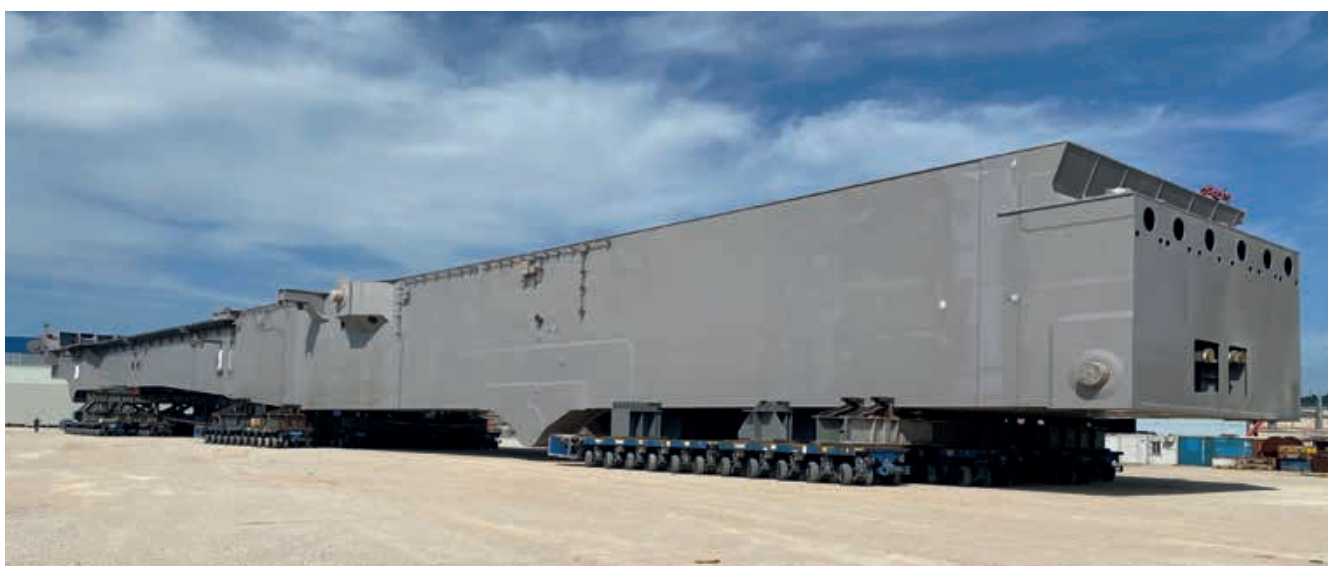
SPMT - carri tipo MSPE EVO 2 - più di 160 assi a disposizione - capacità di carico totale di 9.500 t
