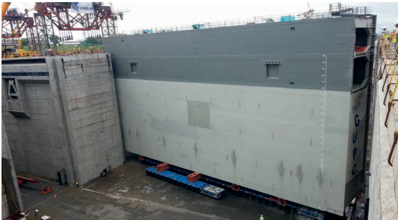
SPMT - carri tipo MSPE EVO 2 - più di 160 assi a disposizione - capacità di carico totale di 9.500 t
