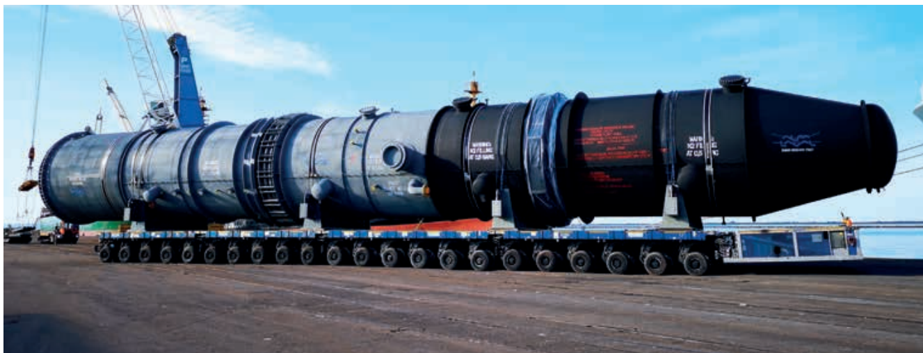
SPMT - carri tipo MSPE EVO 2 - più di 160 assi a disposizione - capacità di carico totale di 9.500 t
